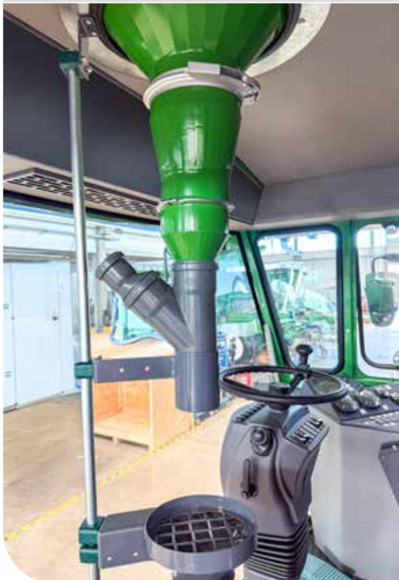
Probenwaage in der Kabine
