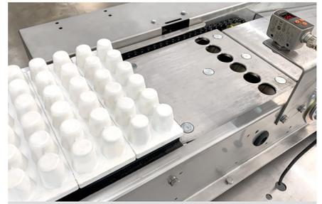
Vollautomatische Beizung von 12-Kammer-Magazinen
