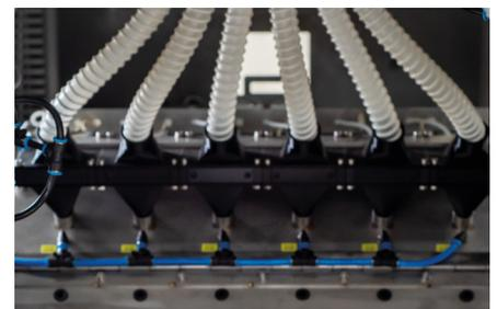
Beizmitteldosierung über 6 einzelne Labor-Schlauchpumpen
