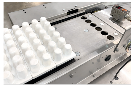
Vollautomatische Beizung von 12-Kammer-Magazinen
